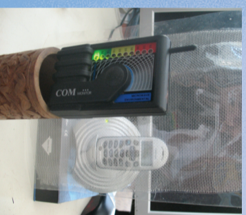
Εικ. 4. Προσθήκη μεταλλικού πλέγματος (δεξιά εικόνα) μειώνει σημαντικά την εκπομπή της ακτινοβολίας από τη βάση ασύρματου τηλεφώνου.
