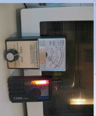
Εικ. 7. Ανίχνευση μαγνητικού πεδίου 50 Hz και ηλεκτρομαγνητικής ακτινοβολίας υψηλής συχνότητας έξω από τον φούβνο μικροκυμάτων κατά τη διάρκεια της λειτουργίας του.
