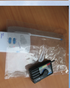
Εικ. 5 Εκπομπή ακτινοβολίας από συσκευή παρακολούθησης βρεφών μπορεί να αποτραπεί προς την κατεύθυνση του βρέφους εάν παρεμβληθεί πλαστικοποιημένο μεταλλικό πλέγμα (δεξιά εικόνα).
