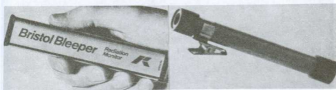
Εικ. 42: Προσωπικοί μετρητές-δοσίμετρα που δείχνουν την ολική συσσωρευμένη έκθεση σε ακτινοβολία φωτονίων ενέργειας 30 Kev μέχρι 2 Men (θάλαμοι ιονισμού).
